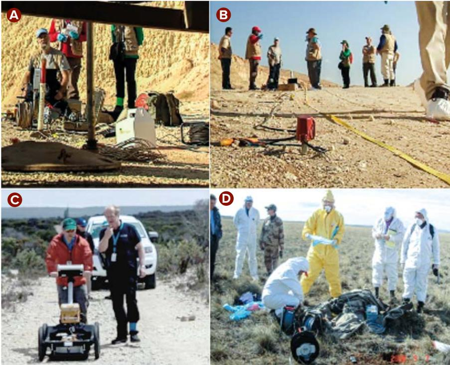
Figura 15: Inspeção no local utilizando métodos geofísicos: (A) métodos geoeletricos, (B) sísmica de refração/reflexão, (C) levantamento com georadar (GPR) e (D) preparativos para medidas de eletrorresistividade e radioatividade.
