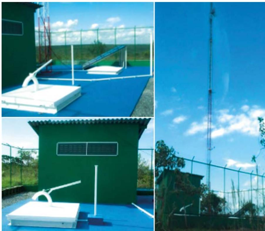
**Figura 17:** Estação sísmica primária PS07. À esquerda: sistema de alimentação com painéis solares; poço do sismômetro e abrigo dos instrumentos. À direita, torre de transmissão de dados para a Estação Central no SIS - UnB (Barros e Fontenele, 2004).
