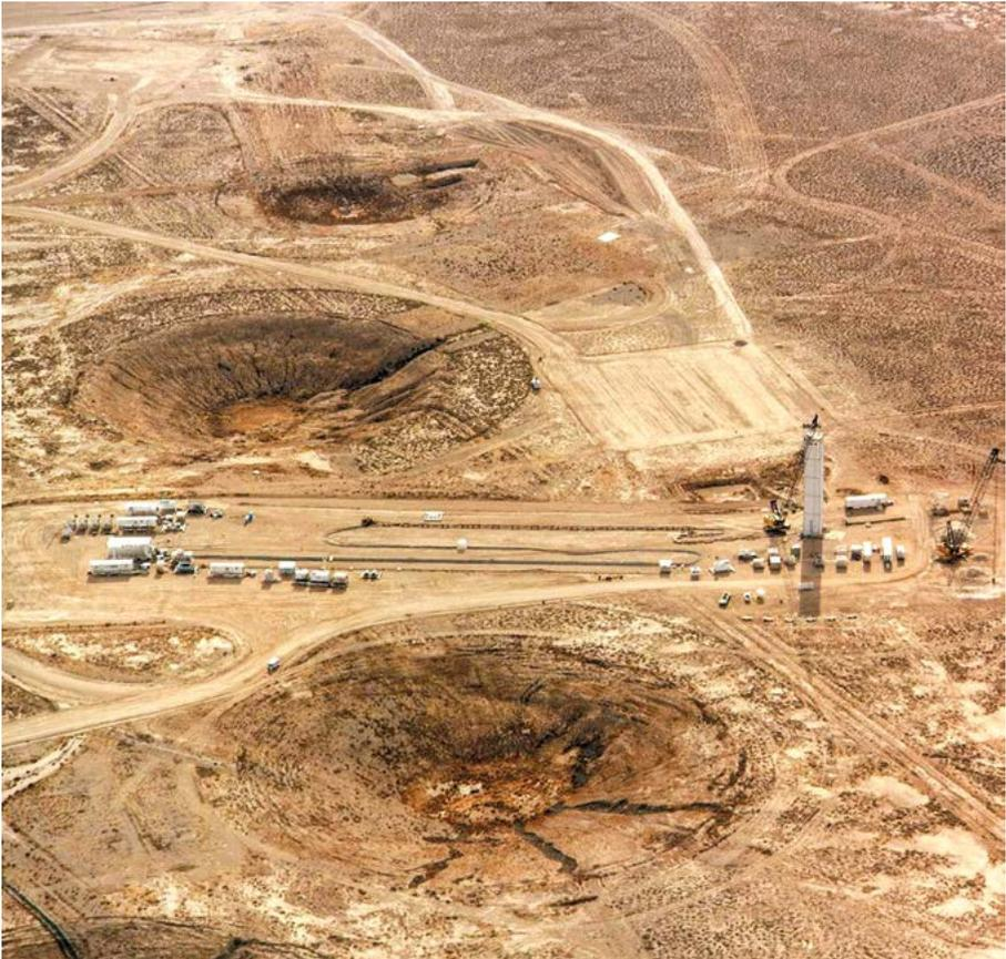
Geram principalmente ondas sísmicas. Entretanto, sinais infrasônicos e hidroacústicos podem estar acoplados (podem estar presentes). Esse tipo de detonação libera também radioisótopos, que podem ser registrados nas estações radionuclídicas (<https://sibnarkomat.livejournal.com/28817546.html>).
