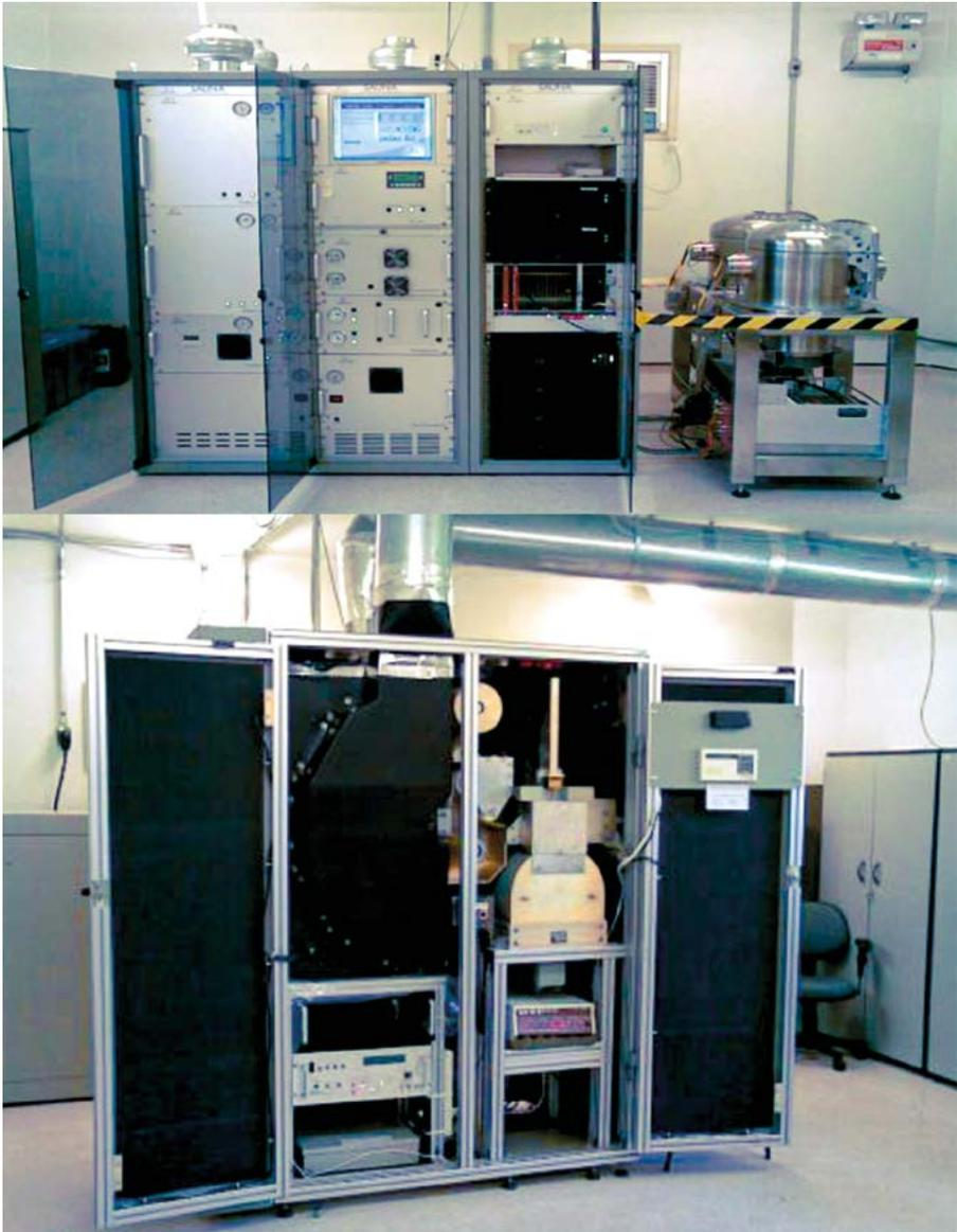
**Figura 23:** Estação de Radionuclídeos e gases nobres (RN11), localizada no Instituto de Radioproteção e Dosimetria na cidade do Rio de Janeiro. Na parte superior, analisador automático de amostras de radionuclídeos e, na inferior, analisador automático de amostras de gases nobres (<http://www.ird.gov.br/index.php/component/content/article/59-ird/laboratorios/101-estacao-de-radionuclideos-do-ctbto>).
